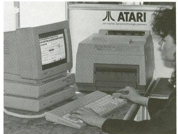
werden. Im Gegensatz zu den sogenannten intelligenten Laserdruckern, bei denen man neue Zeichensätze in Cassettenform nachkaufen muß, genügt beim SLM eine Änderung der Software, die der Anwender (sobald
